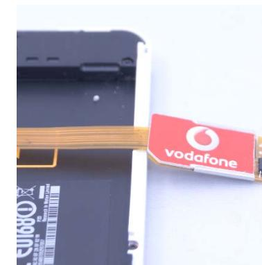
5/6/7. Führen Sie den Adapter über den Akku quer und falten diesen dann im 90° Winkel parallel zum Akku, möglichst mittig zur Gesamtbreite des Handys. Je nach Lage des SIM-Slots in der Regel zur längeren Seite hin!
